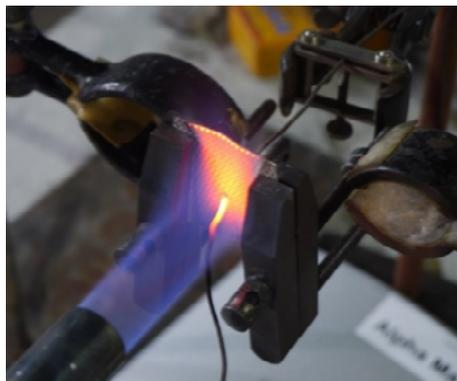
Prüfung der Temperaturbeständigkeit unterschiedlicher Materialien
